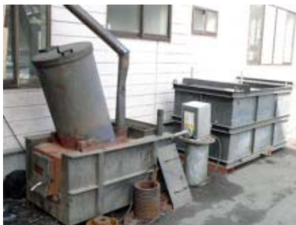
海水による被害を受けた電動機から潮を除去するための装置。身近にある部材を活用して作った
